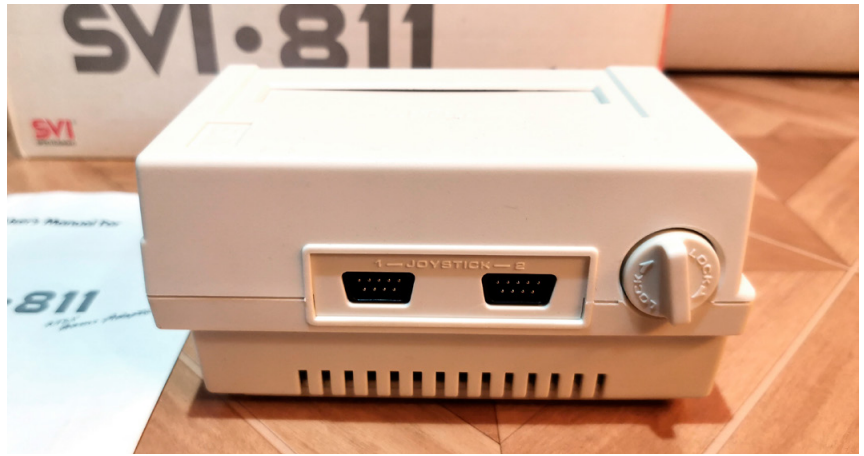
Kuvan ulkoinen MSX-laajennusosa (SVI-811B) kiinnittyy koneen sisälle vaakatasoon asennettavaan ISA-korttiin (SVI-811A) 50-pinnisellä liittimellä sekä oikealla näkyvällä sormiruuville.
